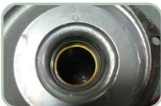
Sin depósitos ni fricción en la bomba, incluso después de 360 horas de funcionamiento continuo.
